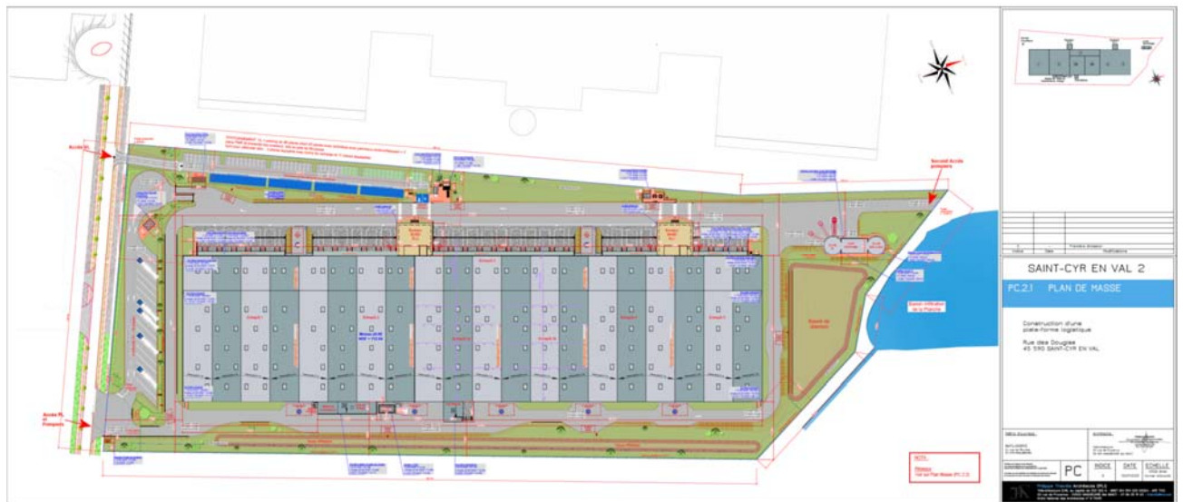
Figure 2 : Plan de masse du projet avec le positionnement de l'ouvrage de gestion des eaux pluviales au droit du site daté 15/07/2021 (source : NG CONCEPT)
